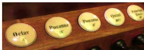
Durch das Ziehen eines Registers wird die **Information mittels Luft über lange Messingrohre weitergeleitet** und schließlich ein Ventil betätigt. Dies bewirkt, dass in der Windlade die sogenannte Kanzelle von diesem Register mit Wind (also mit Luft) gefüllt wird.
