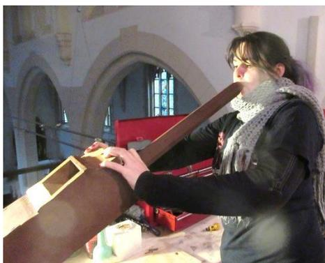
Bild oben: Mitarbeiterin der Orgelbaufirma Bodem im November 2016 beim Anblasen einer Orgelpfeife zwecks Überprüfung, ob die Pfeife dicht ist.
