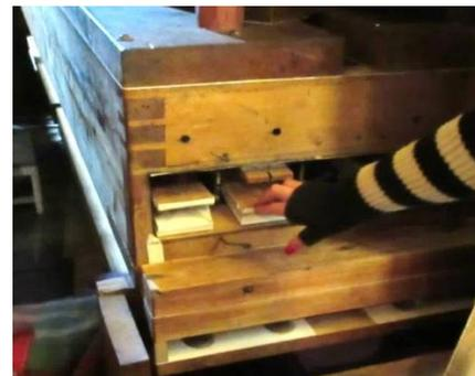
Das Bild zeigt eine der Windladen mit den Registern, die geöffnet und geschlossen werden können.
