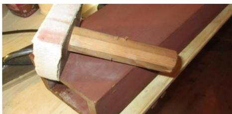
Die **Tonhöhe wird mit Hilfe des Stimmstocks** (siehe Bild oben) **eingestellt**, der mehr oder weniger tief in die Orgelpfeife hinein gedrückt wird. Damit der Stimmstock vollständig dicht ist, wird er mit Leder ummantelt.
