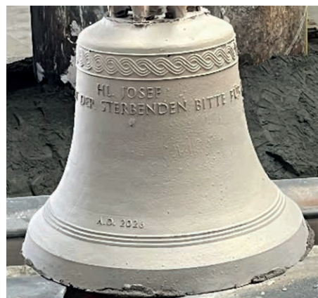
... zeigt sich die frisch gegossene Glocke
