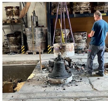
Gussbehälter wird abgenommen.
