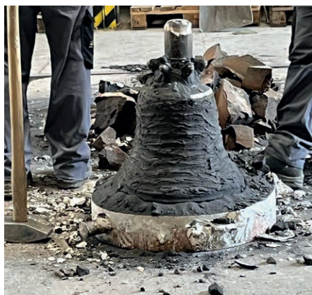
Abschlagen der Lehmschicht. Darunter ...
