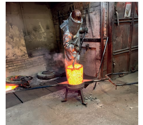
Die Schlacke wird entfernt
